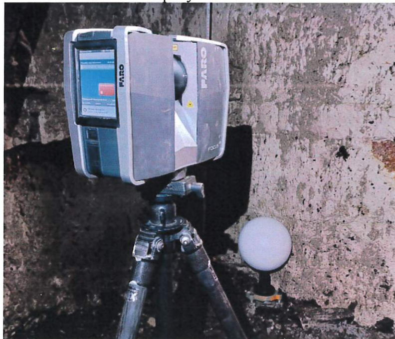
Fot. 5 Skanowanie laserowe na dnie studni.
