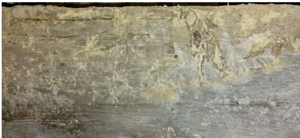
Fotografia 19 Sznury strocza domowego na drewnianej desce znajdującej się w lapidarium.
